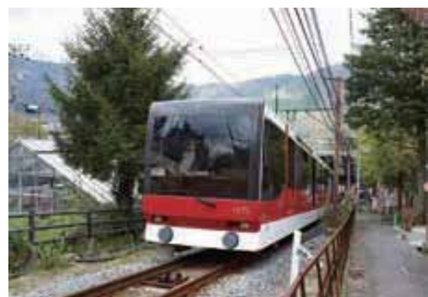
箱根登山ケーブルカーの現在の車両(4代目)。スイスのガングロフ社で製造され、平成7(1995)年に登場した。
